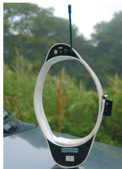
Ошейник со спутниковым передатчиком системы GPS ARGOS для мечения крупных хищных млекопитающих — амурских тигров, леопардов, медведей
